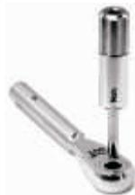
2. Svitare la vite del coperchio di alloggiamento del gruppo cricchetto utilizzando la ghiera di regolazione che funge da cacciavite.
